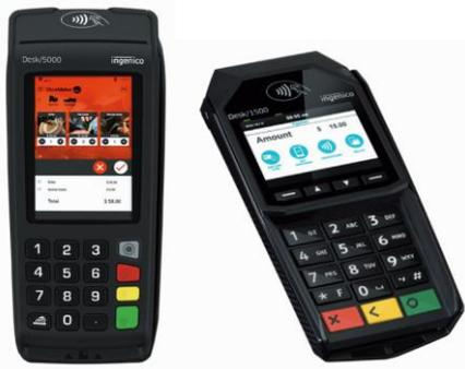
Le DESK 5000 et le pinpad DESK 1500 se connectent en USB. Il faut installer le pilote "IngenicoUSBDrivers\_3.26\_setup\_SIGNED.exe". Le câble USB n'est pas fourni avec le DESK 5000. Il est donc nécessaire d'en commander un séparément. La référence chez Ingenico est la suivante : câble USB coudé (296171895) (1.50 m de longueur).
