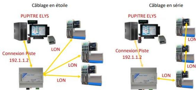
Pour plus de redondance et réduire les coûts du tirage des câbles LON, il est possible d'installer un boîtier Easylon Router+ par pompe.
