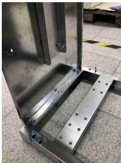
Placer la pièce de support plate sur la base du cadre et aligner les trous de la pièce de support avec les trous du cadre.
