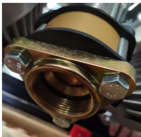
5 ) L'ensemble est fixé à la manchette côté bride triangulaire « mobile » avec 3 vis/rondelles/écrous fournis.
