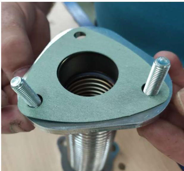
Ajouter ensuite le clapet Tatsuno fourni avec le distributeur, puis mettre le joint en liège (marron) à fin d'obtenir le montage suivant :
