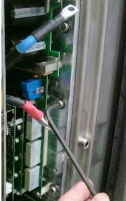
Utiliser une des vis M6 et la visser dans le trou taraudé prévu à cet effet pour décoller le module du dissipateur.
