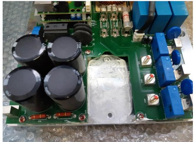
Matériel nécessaire au bon remontage du pont de diode
