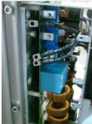
Dévisser les boulons de fixation des câbles de sortie.
