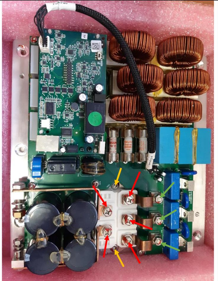
Photo du pont de diode une fois démonté !
