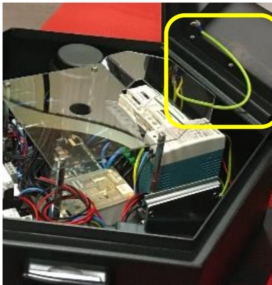
Figure 1. Raccordement de la terre principale sur le goujon de terre sous le socle
