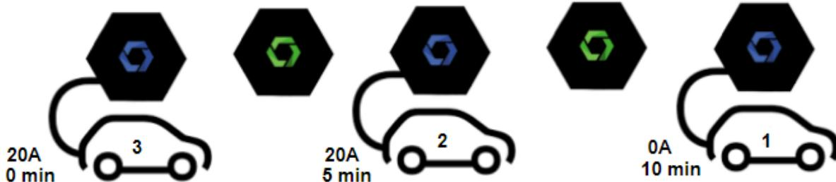
**Attention :** chaque lancement de calcul produit par le branchement ou le débranchement d'un véhicule réinitialise le compteur de temps défini sur 900 secondes (15 minutes).
