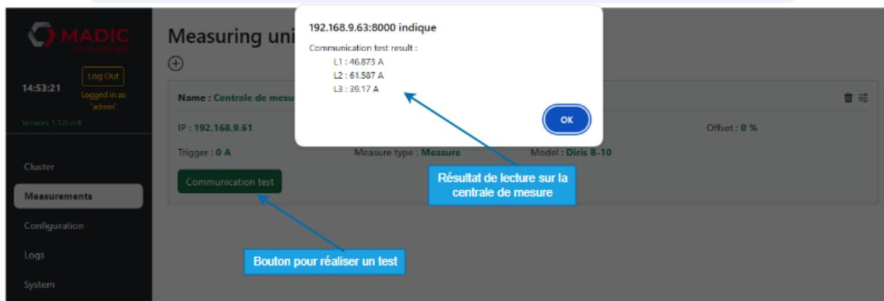
Pour l'utiliser il suffit maintenant de l'associer au contrôleur local d'énergie défini sur la page d'accueil. Pour cela, choisir la centrale de mesure désirée dans la liste déroulante du champ **Measuring Unit** dans les paramètres de la grappe.
