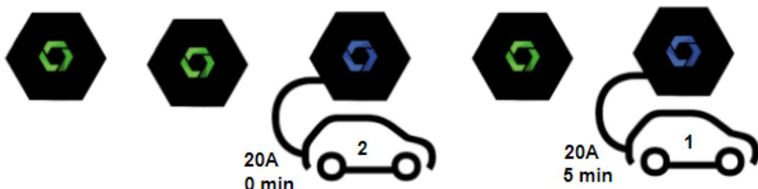
3. Un troisième véhicule arrive 10 minutes plus tard après le premier véhicule, du coup  $40 \text{ A} / 3 \text{ véhicules} = 13.3 \text{ A} < 14 \text{ A}$ , donc inférieur au courant minimum défini.
