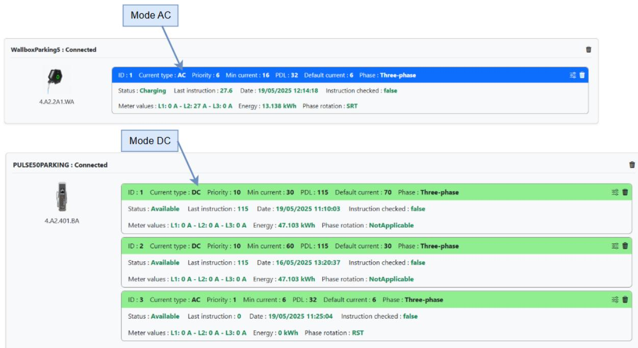
En fonction du type de connecteur des ajustements de consigne sont réalisés automatiquement par le contrôleur :
