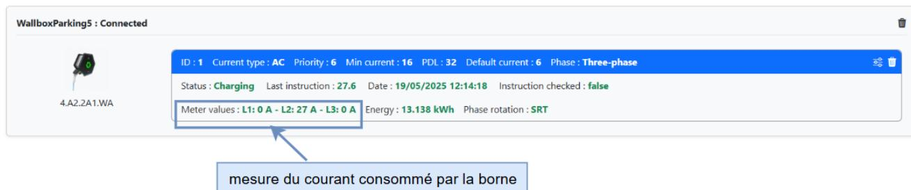
Si le courant mesuré est stable durant plus d'une minute, un ajustement de consigne est réalisé sur la valeur mesurée :
