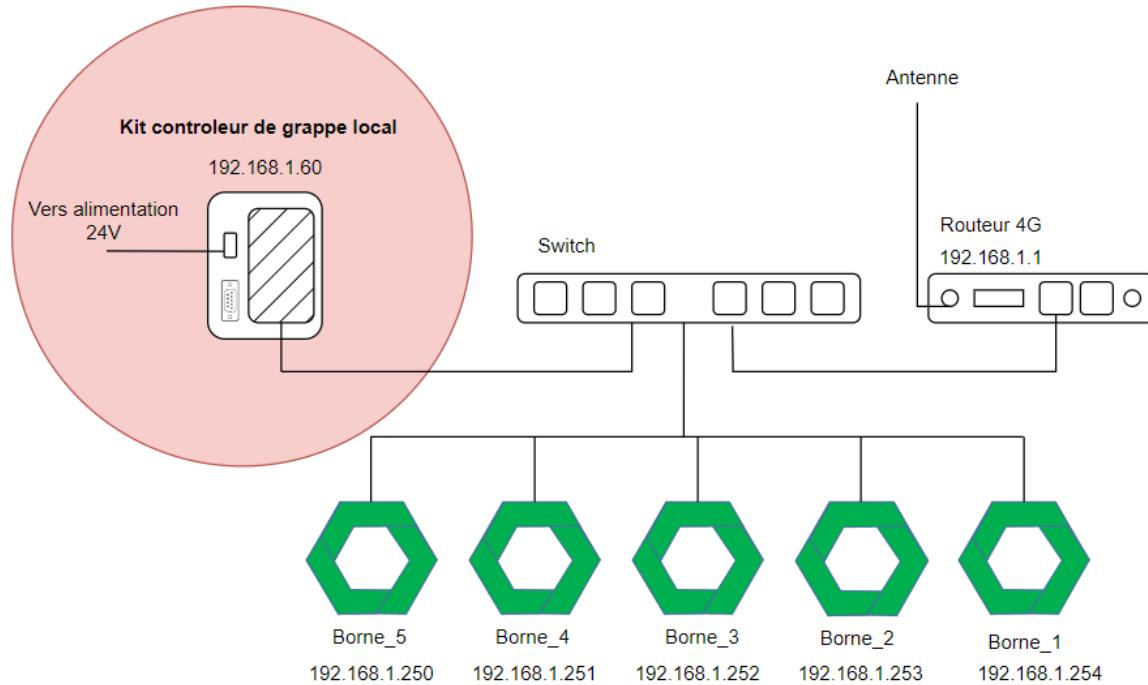
Le contrôleur de grappe se monte sur un rail DIN de l'armoire électrique. Il est alimenté en 24V à l'aide d'un câble fourni.
